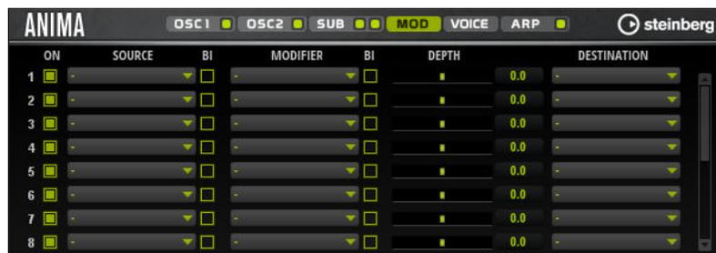
モジュレーションマトリクスでは、最大16種類のモジュレーションを使用できます。それぞれのモジュレーションには、デプスのソース、モディファイアーおよびデスティネーションを設定できます。それぞれのソースとモディファイアーの極性は、単極性と双極性を切り替えられます。
