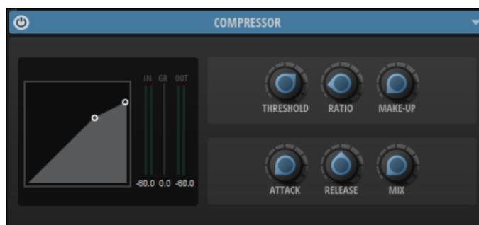
Die IN- und OUT-Anzeigen zeigen den Pegel vor und nach dem Kompressor an. Die **GR**-Anzeige (Gain Reduction) in der Mitte zeigt die aktuelle Pegelabsenkung an. Der Spitzenpegel wird unter jeder Anzeige angezeigt. Sie können die Spitzenpegelanzeige zurücksetzen, indem Sie in das Wertefeld klicken.
