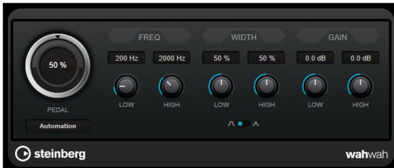
Sie können die Frequenz, Breite und Verstärkung für die **Low**- und **High**-Positionen unabhängig voneinander einstellen. Der Übergangspunkt zwischen diesen Positionen liegt bei 50.
