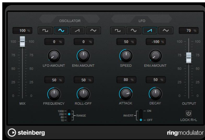
La modulation en anneau consiste à multiplier deux signaux audio. La sortie modulée en anneau contient des fréquences supplémentaires générées par la somme et la différence des fréquences des deux signaux.
