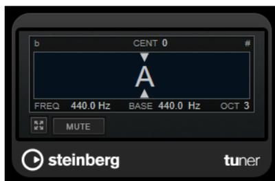
La hauteur actuellement jouée est représentée par une note sur l'affichage graphique. Les deux flèches indiquent l'écart de hauteur. L'écart est également indiqué en haut de l'affichage. Quand la hauteur jouée est plus basse que la note, l'indicateur de hauteur se trouve à gauche de la note. Quand la hauteur jouée est plus haute que la note, l'indicateur de hauteur se trouve à droite de la note.
