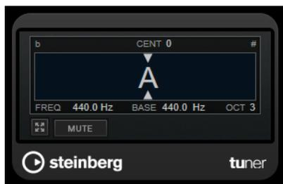
Графический дисплей показывает в виде ноты высоту исполняемого в данный момент звука. Две стрелки отображают любое отклонение высоты звучания. Отклонение высоты также показано в верхней части дисплея. Если исполняемая нота звучит ниже необходимой высоты, индикатор высоты смещён влево. Если исполняемая нота звучит выше, индикатор высоты смещён вправо.
