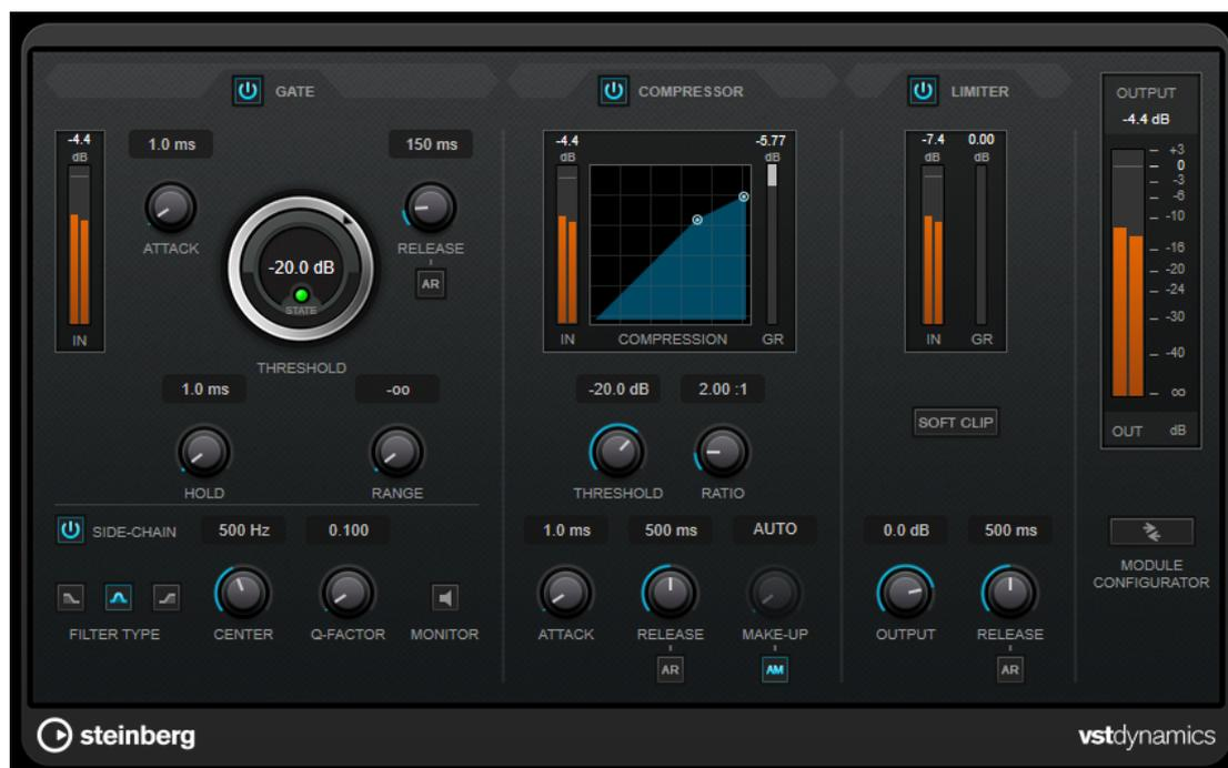
Окно разделено на три секции, содержащие органы управления и измерители для каждого эффекта. Включайте отдельные эффекты, используя кнопки **Gate** (Гейт), **Compressor** (Компрессор) и **Limiter** (Лимитер). Вы можете выбрать один из трёх вариантов включения, используя кнопку **Module Configurator** (Конфигуратор модулей).
