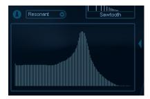
È qui che vengono creati i profili (caratteristiche della risposta di frequenza) per i due filtri spettrali risonanti a 128 poli A e B.
