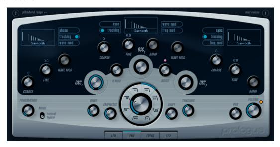
Questa sezione contiene dei parametri che agiscono sui 3 oscillatori. I parametri si trovano nella metà superiore del pannello dell'instrument.
