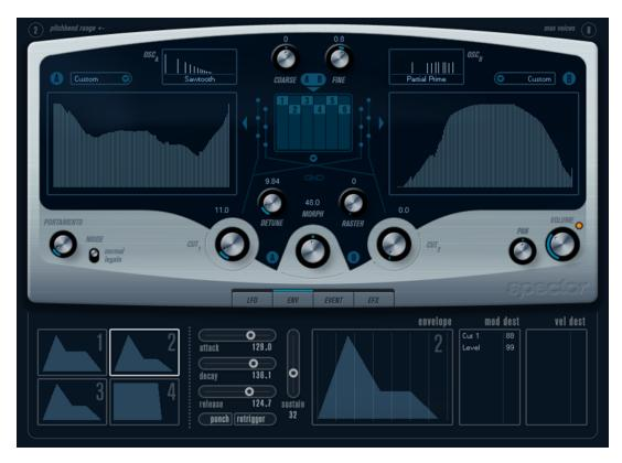
Il processo di sintesi utilizzato da **Spector** si basa su un filtro spettrale. Ciò consente di specificare la risposta in frequenza disegnando il profilo del filtro direttamente nel display dello spettro. In forma semplificata, il percorso del segnale è il seguente:
