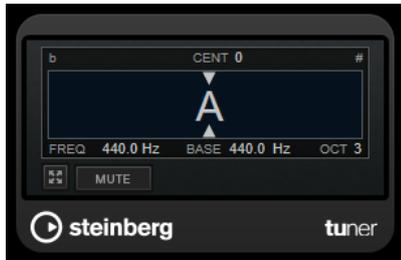
El visor gráfico indica el tono tocado actualmente como nota. Las dos flechas indican cualquier desviación de tono. La desviación también se muestra en el área superior del visor. Si la nota tocada es bemol del tono, el indicador de tono se encuentra a la izquierda. Si la nota tocada es sostenido, el indicador de tono se encuentra a la derecha.
