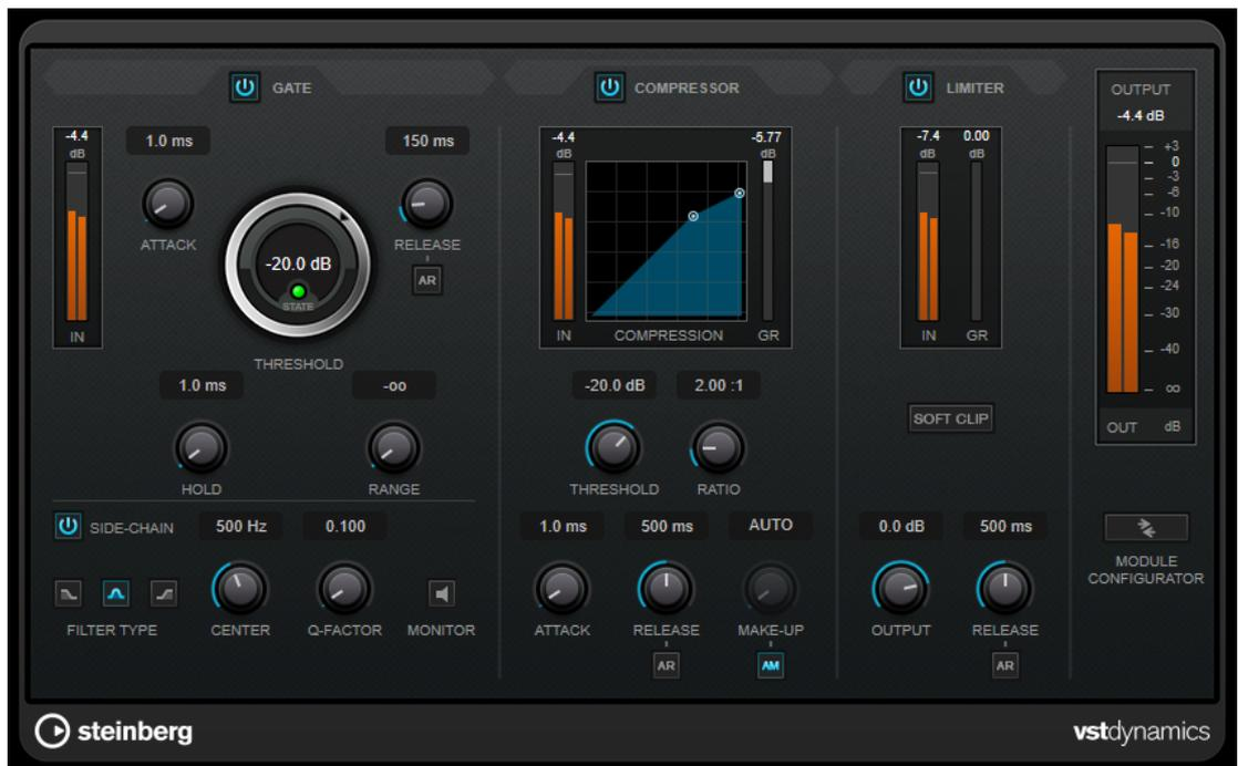
La ventana se divide en tres secciones, cada una conteniendo controles y medidores para cada efecto. Active los efectos individuales usando los botones **Gate**, **Compressor** y **Limiter**. Puede seleccionar entre tres opciones de enrutado diferentes usando el botón **Module Configurator**.
