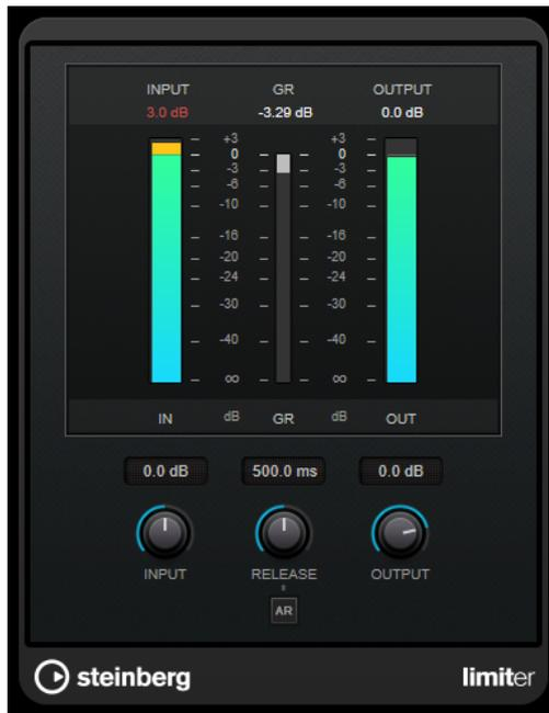
**Limiter** puede ajustar y optimizar automáticamente el parámetro **Release** según el material de audio, pero también se puede ajustar manualmente. El **Limiter** también tiene medidores diferentes para la entrada, la salida y la cantidad de limitación (medidores centrales).
