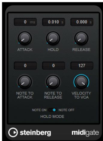
Una puerta (gate), en su forma fundamental, silencia las señales de audio por debajo de un umbral establecido. Si una señal excede el nivel establecido, la puerta se abre y deja pasar la
