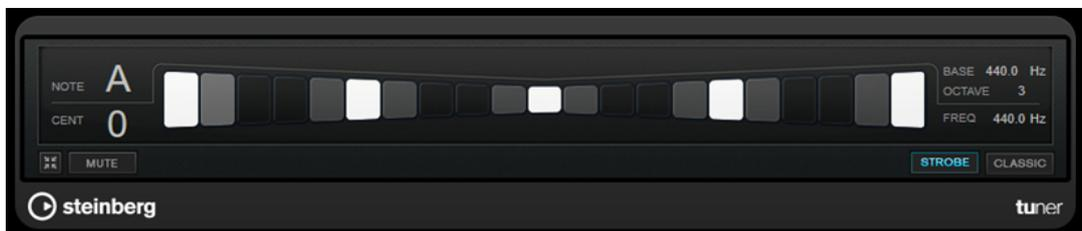
En mode **Classic**, les écarts de hauteur sont représentés par un indicateur. Quand la hauteur jouée est plus basse que la note, l'indicateur se trouve à gauche du centre. Quand la hauteur jouée est plus haute que la note, l'indicateur se trouve à droite du centre. La hauteur est correcte quand l'indicateur est centré et de couleur grise.
