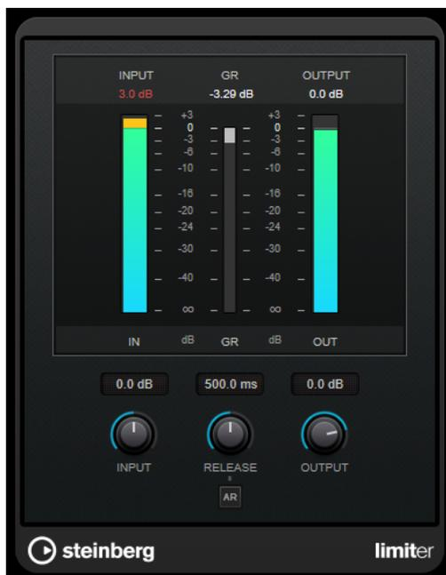
Le plug-in **Limitter** peut régler et optimiser automatiquement le paramètre **Release** en analysant les données audio. Ce paramètre peut également être configuré manuellement. **Limitter** est également doté de vumètres séparés pour les niveaux d'entrée, de sortie et de limitation (celui du milieu).
