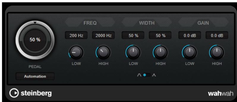
Vous pouvez définir indépendamment la fréquence, la largeur et le gain des positions de pédale **Low** (basse) et **High** (haute). Le point d'équilibre entre ces deux positions se situe à 50.
