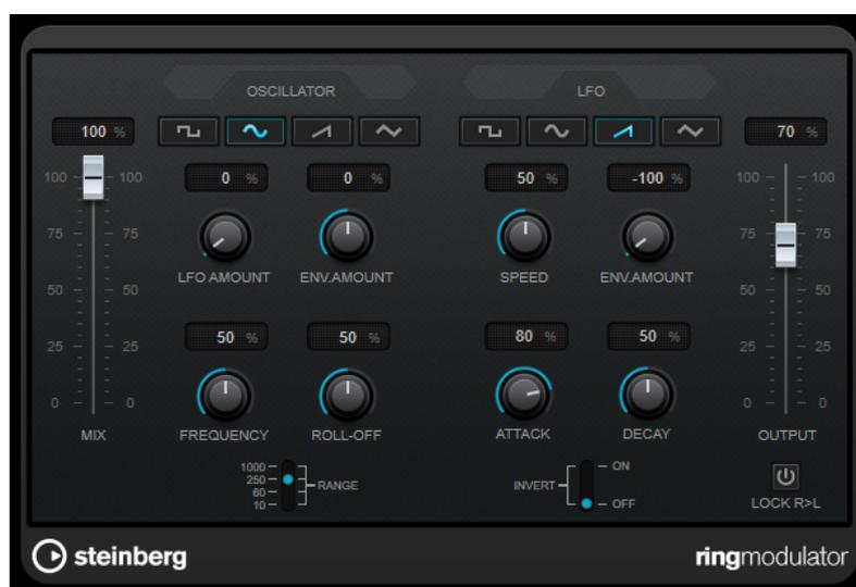
Кольцевые модуляторы работают путем умножения двух аудиосигналов. Выход промодулированного таким образом сигнала содержит добавленные частоты, генерируемые суммой и разностью между частотами двух сигналов.
