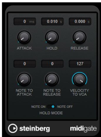
Гейт по сути подавляет аудио сигналы с уровнем ниже определённого порога. Если уровень сигнала превышает порог, гейт открывается и пропускает сигнал. Сигналы с уровнем ниже установленного порога не пропускаются. Однако **MIDI Gate** переключается не с использованием порогового уровня, а с использованием MIDI нот. Поэтому для его работы требуются как аудио, так и MIDI данные.
