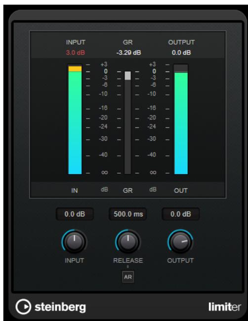
**Limiter** способен настраивать и оптимизировать параметр **Отпускание** автоматически в соответствии с аудиоматериалом или позволяет настраивать его вручную. **Limiter** обладает отдельными измерителями для входа, выхода и степени лимитирования (средние измерители).
