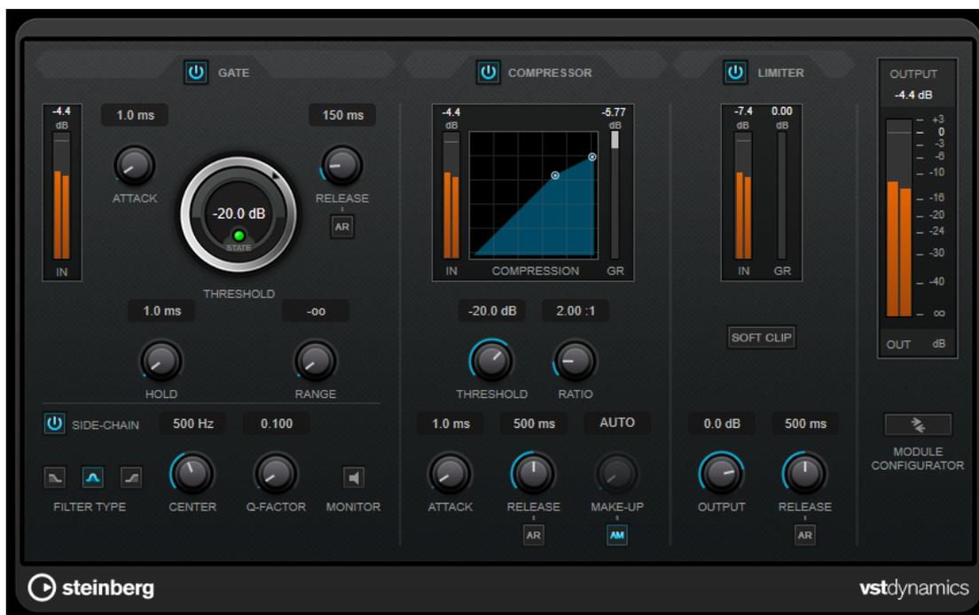
ウィンドウは3つのセクションに分かれており、各エフェクト用のコントロールとメーターが表示されます。「Gate」、「Compressor」、「Limiter」の各ボタンを使用して個々のエフェクトをオンにします。「Module Configurator」ボタンを使用して、3種類のルーティングオプションを選択できます。
