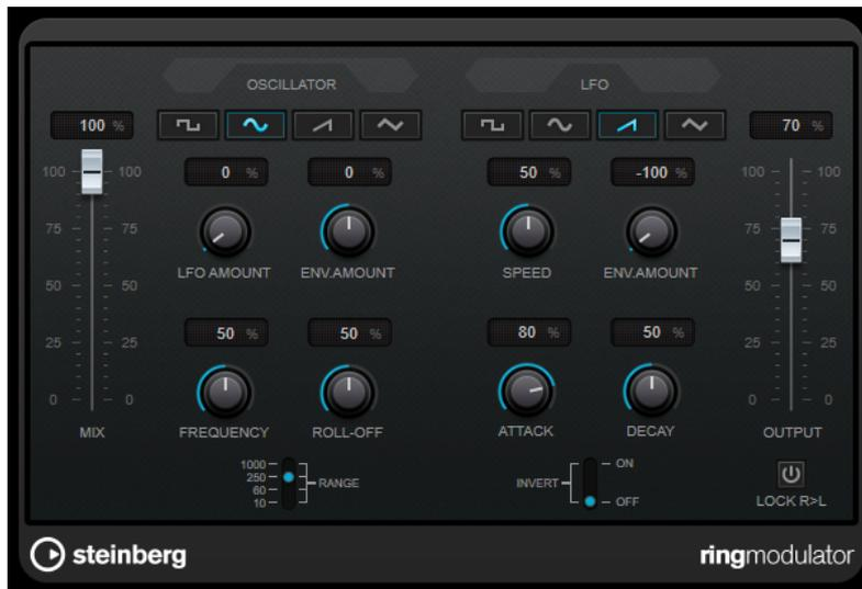
RingModulator は、2つのオーディオ信号を掛け合わせることによって動作します。リングモジュレーターからは2つの信号の周波数の和と差により発生した周波数が追加されて出力されます。
