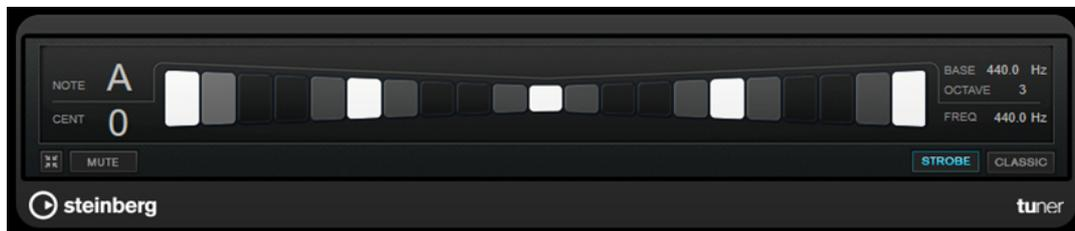
「Classic」モードでは、インジケーターがピッチのずれを示します。演奏されているノートが低い場合、インジケーターが中央より左に配置されます。演奏されているノートが高い場合、インジケーターが中央より右に配置されます。正しいピッチを演奏すると、ピッチが中央に配置されてグレーになります。
