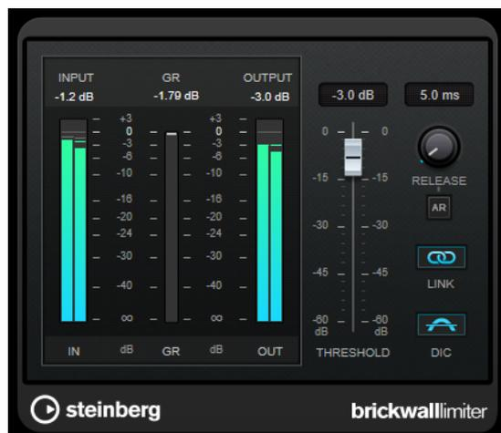
Durch seine schnelle Attack-Zeit kann der **Brickwall Limiter** sogar kurze Audiopegelspitzen reduzieren, ohne hörbare Artefakte zu erzeugen. Dieses PlugIn erzeugt jedoch eine Latenz von 1
