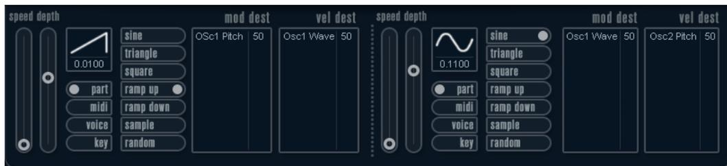
Je nach ausgewähltem Preset sind ggf. bereits Modulationsziele zugewiesen. Diese werden für jeden LFO im Bereich **Mod Dest** angezeigt.
