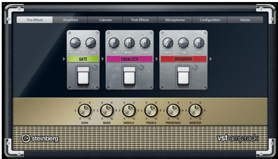
Oben im PlugIn-Bedienfeld befinden sich sechs Schalter, die entsprechend der Position der dazugehörigen Elemente in der Signalkette angeordnet sind. Diese Schalter öffnen verschiedene Seiten im Anzeigebereich des PlugIn-Bedienfelds: **Pre-Effects** (vorgeschaltete Effekte), **Amplifiers** (Verstärker), **Cabinets** (Lautsprecherboxen), **Post-Effects** (nachgeschaltete Effekte), **Microphone Position** (Mikrofonposition), **Master** und **Configuration** (Konfiguration).
