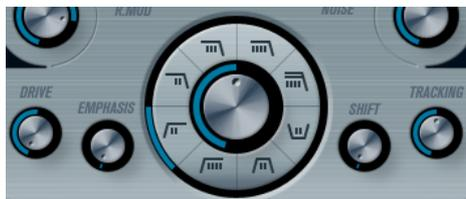
In der Mitte des Bedienfelds befinden sich die Filter-Parameter. Der Regler in der Mitte stellt die Arbeitsfrequenz des Filters ein, der äußere Ring den Filtertyp.
