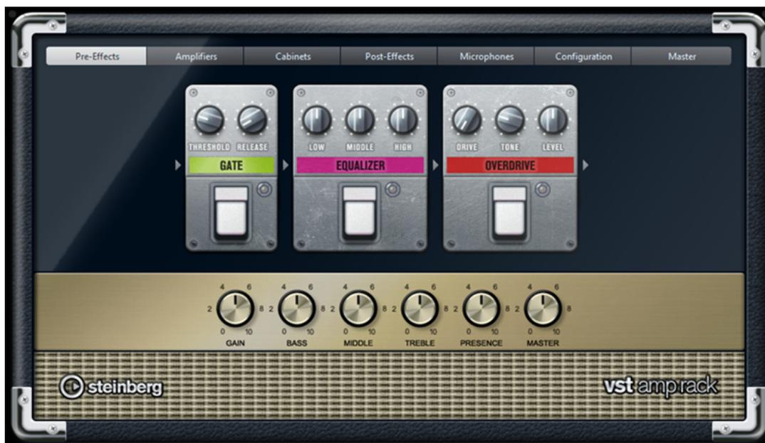
プラグインパネル上部には6個のボタンがあり、シグナルチェーンの各要素の位置に合わせて配置されています。各ボタンを押すと、プラグインパネルのディスプレイに異なるページ (「Pre-Effects」、 「Amplifiers」、 「Cabinets」、 「Post-Effects」、 「Microphones」、 「Configuration」、 「Master」) が表示されます。
