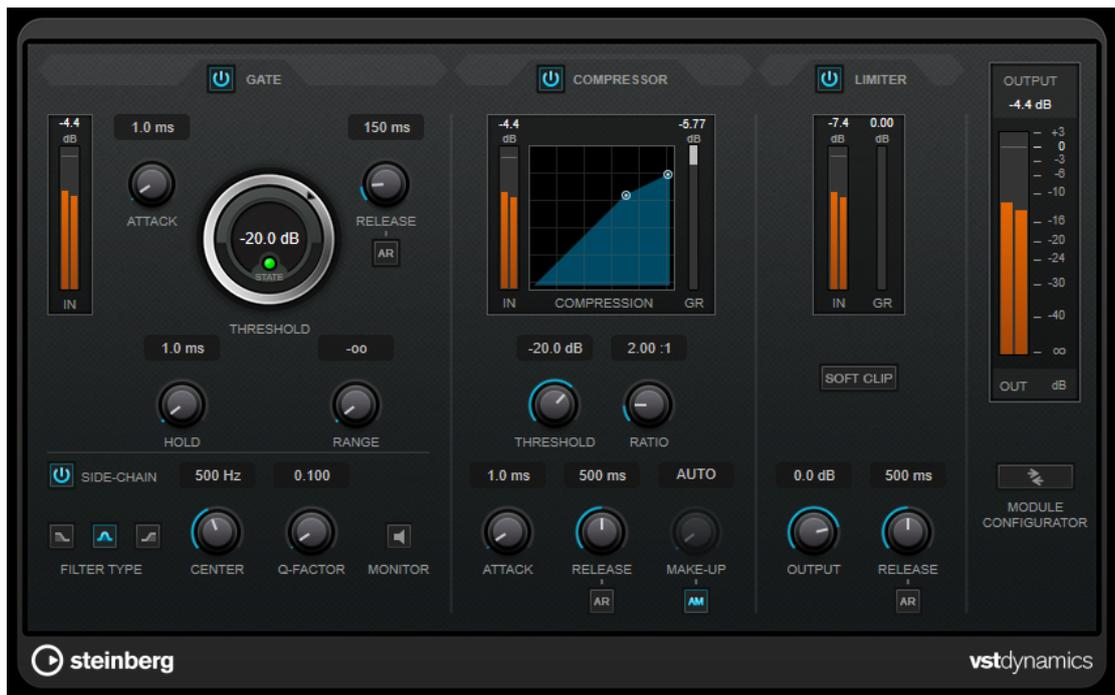
La ventana se divide en tres secciones, cada una conteniendo controles y medidores para cada efecto. Active los efectos individuales usando los botones **Gate**, **Compressor** y **Limiter**. Puede seleccionar entre tres opciones de enrutado diferentes usando el botón **Module Configurator**.
