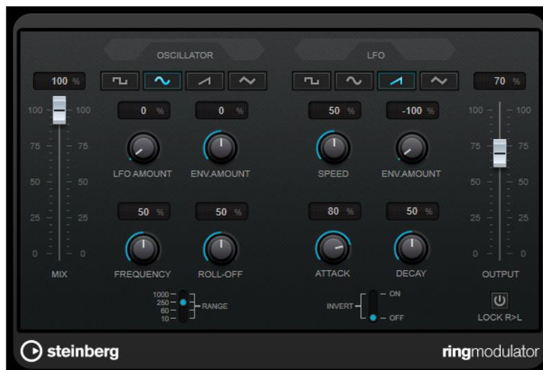
Los moduladores de anillo funcionan multiplicando dos señales de audio. La salida de una señal sujeta a modulación en anillo contiene frecuencias añadidas generadas por la suma de, y la diferencia entre, las dos señales.
