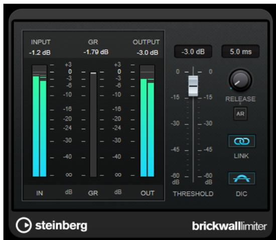
Debido a su rápido tiempo de ataque, **Brickwall Limiter** puede reducir incluso los picos de nivel del audio más corto sin crear anomalías audibles. Sin embargo, este plug-in crea una latencia de 1 ms. **Brickwall Limiter** ofrece medidores diferentes para la entrada, la salida y la cantidad de limitación. Coloque este plug-in al final de la cadena de señal, antes del dithering.
