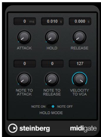
Una puerta (gate), en su forma fundamental, silencia las señales de audio por debajo de un umbral establecido. Si una señal excede el nivel establecido, la puerta se abre y deja pasar la señal a través. Las señales por debajo del nivel establecido se silencian. **MidiGate**, sin embargo, no se activa por niveles de umbral, sino por notas MIDI. Por lo tanto, necesita tanto datos de audio como datos MIDI para funcionar.
