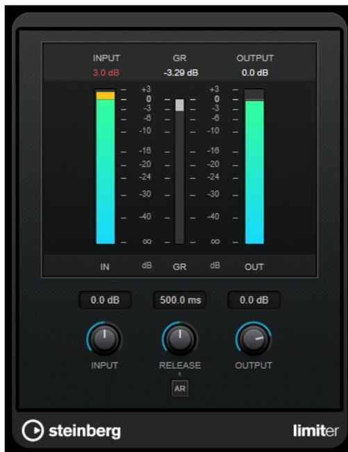
**Limiter** puede ajustar y optimizar automáticamente el parámetro **Release** según el material de audio, pero también se puede ajustar manualmente. **Limiter** tiene medidores diferentes para la entrada, la salida y la cantidad de limitación (medidores centrales).
