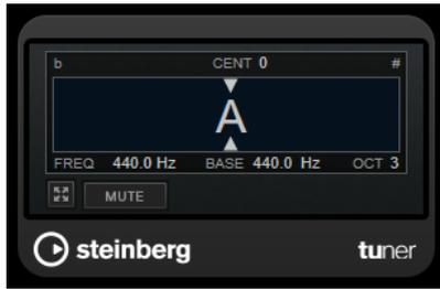
El visor gráfico indica el tono tocado actualmente como nota. Las dos flechas indican cualquier desviación de tono. La desviación también se muestra en el área superior del visor. Si la nota tocada es bemol del tono, el indicador de tono se encuentra a la izquierda. Si la nota tocada es sostenido, el indicador de tono se encuentra a la derecha.
