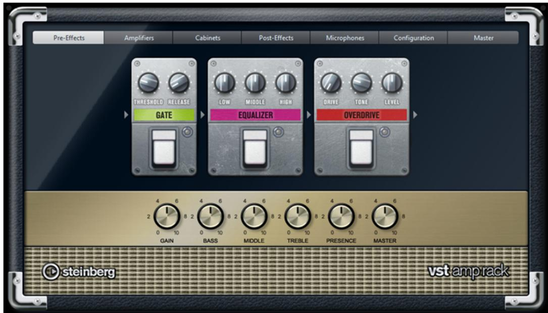
En la parte superior del panel del plug-in hay seis botones, colocados según la posición de los elementos correspondientes en la cadena de señal. Estos botones abren diferentes páginas en la sección de visualización del panel del plug-in: **Pre-Effects**, **Amplifiers**, **Cabinets**, **Post-Effects**, **Microphones**, **Configuration** y **Master**.
