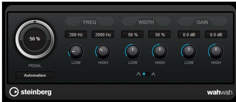
Puede especificar independientemente la frecuencia, la amplitud y la ganancia de las posiciones **Low** y **High** del pedal. El punto de cruce entre las posiciones Lo y Hi del pedal está en 50.
