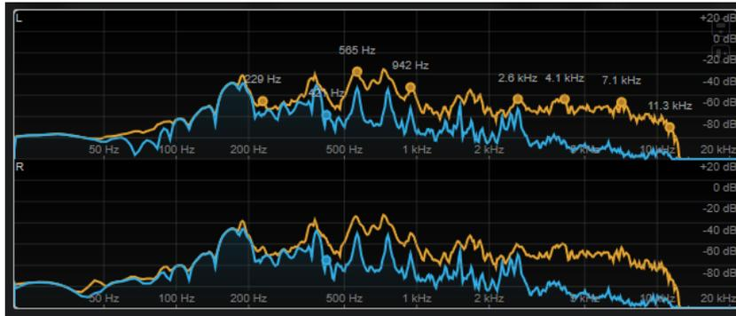
Das Frequenzspektrum wird als linearer Graph angezeigt. Wenn Sie mit dem Mauszeiger auf die Anzeige fahren, wird eine orangefarbene Spitzenkurve angezeigt. Fahren Sie mit dem Mauszeiger über die Kurven, um die lokalen Maximalwerte in Hz anzuzeigen. Drücken Sie die **Strg-Taste/Befehlstaste**, um die Maximalwerte in dB anzuzeigen, oder drücken Sie die **Umschalttaste**, um ihre Tonhöhe anzuzeigen.
