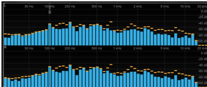
Fahren Sie mit dem Mauszeiger über einen Balken, um den Frequenzbereich in Hz anzuzeigen. Drücken Sie die **Strg-Taste/Befehlstaste**, um den aktuellen Wert in dB anzuzeigen, oder drücken Sie die **Umschalttaste**, um seinen Tonhöhenbereich anzuzeigen.
