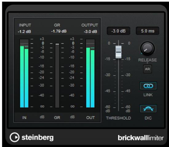
Durch seine schnelle Attack-Zeit kann der **Brickwall Limiter** sogar kurze Audiopegelspitzen reduzieren, ohne hörbare Artefakte zu erzeugen. Dieses PlugIn erzeugt jedoch eine Latenz von 1 ms. **Brickwall Limiter** bietet separate Anzeigen für den Eingangs- und Ausgangspegel sowie für den Grad der Begrenzung. Fügen Sie dieses PlugIn am Ende der Signalkette ein, vor dem Dithering.
