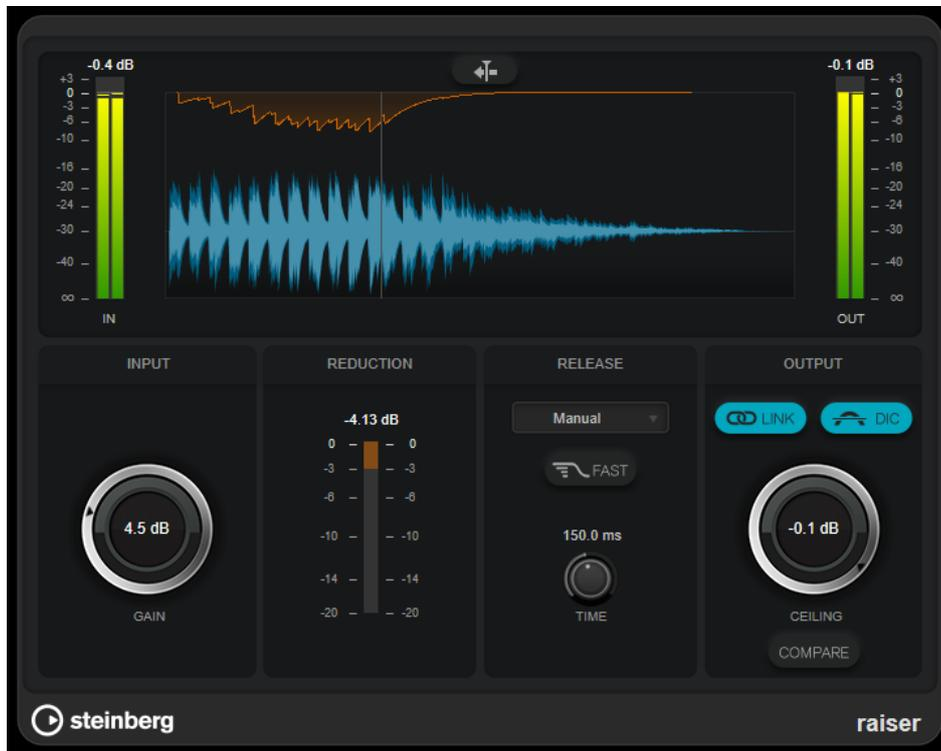
**Raiser** kann den **Release**-Parameter automatisch entsprechend dem Audiomaterial anpassen und optimieren; Sie können den Parameter aber auch manuell einstellen. **Raiser** bietet auch separate Meter für den Eingangs- und Ausgangspegel sowie für den Grad des Limitings (mittleres Meter).
