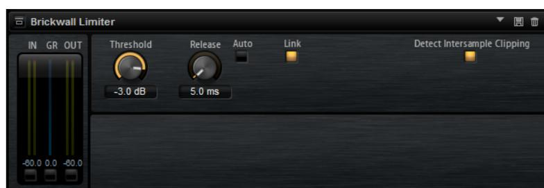
Grâce à son attaque rapide, Brickwall Limiter peut réduire les crêtes audio les plus courtes sans engendrer de parasites sonores. Toutefois, ce plug-in génère une latence de 1 ms. Brickwall Limiter est doté de plusieurs vumètres qui indiquent le niveau d'entrée, le niveau de sortie et le niveau de limitation appliqué.
