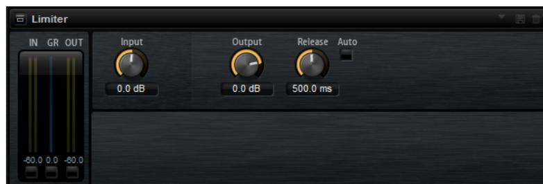
Les vumètres d'entrée et de sortie indiquent le niveau avant et après la limitation. Le vumètre de réduction de gain (GR) au milieu indique l'atténuation appliquée au niveau du son.
