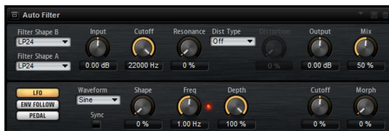
La fréquence de coupure et le morphing entre les deux formes de filtre peuvent être contrôlés via une pédale de contrôle, un LFO ou un profileur d'enveloppe (enveloppe follower).
