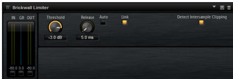
Grâce à son attaque rapide, Brickwall Limiter peut réduire les crêtes audio les plus courtes sans engendrer de parasites sonores. Toutefois, ce plug-in génère une latence de 1 ms. Brickwall Limiter est doté de plusieurs vumètres qui indiquent le niveau d'entrée, le niveau de sortie et le niveau de limitation appliqué.
