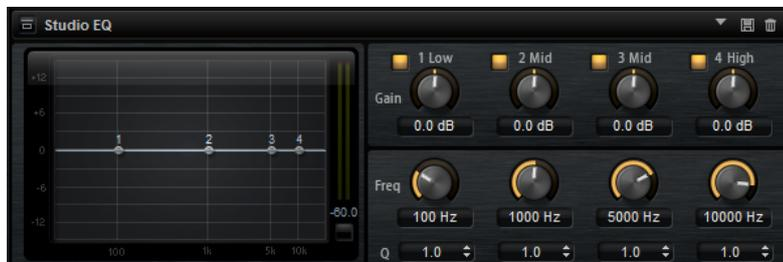
4つの周波数帯域で音質を補正できます。中域の2つはピークフィルターの働きをし、低域と高域はシェルピングフィルターの働きをします。全帯域が完全にパラメトリックになっており、ゲイン、周波数、およびQを設定できます。各周波数帯域について、次のコントロールを使用できます。
