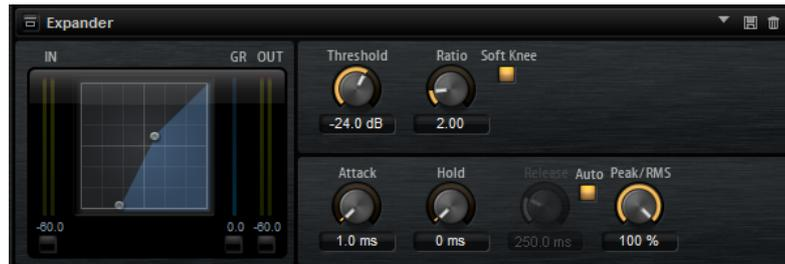
左側のグラフィックコントロールはエキスパンダー曲線を表わしています。このコントロールのハンドルを操作すると「スレッシュホールド」と「レシオ」の値を編集できます。入/出力メーターは拡大前と後のレベルを表示します。ゲインリダクションメーターは現在のレベル減衰を表示します。
