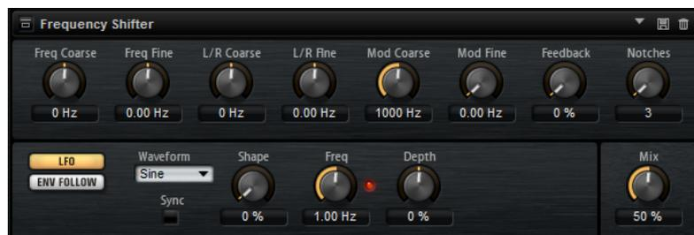
周波数を倍数でシフトし、倍音の関係を保つピッチシフターとは異なり、周波数シフターは倍音の関係を変化させます。そのため、周波数シフトの量を大きくすると不協和音になります。さらに、Frequency Shifter がオフセットを足して周波数を変えるのに対し、ピッチシフターは周波数に倍数を掛けます。Frequency Shifter では、高域より低域の方が周波数変化の割合が大きくなります。たとえば、周波数が 100Hz、1000Hz、10000Hz の入力信号に対して 100Hz ずつ周波数をシフトすると、結果の周波数は 200Hz、1100Hz、10100Hz になります。
