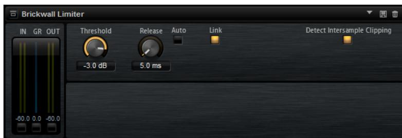
アタックタイムが早いいため、不自然な響きを発生させずに、瞬発的なオーディオレベルピークも低減できます。ただし、1ミリ秒のレイテンシーが発生します。Brickwall Limiter には、入力、出力、および制限の量ごとのメーターがあります。
