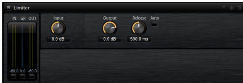
入/出力メーターはリミッター作動前と後のレベルを表示します。中央のゲインリダクションメーターは現在のレベル減衰を表示します。
