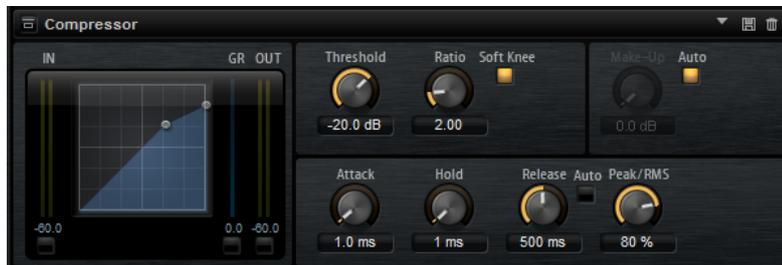
左側のグラフィックコントロールはコンプレッサー曲線を表わしています。このコントロールのハンドルを操作すると「スレッシュホールド」と「レシオ」の値を編集できます。入/出力 VU メーターは圧縮前と後のレベルを表示します。ゲインリダクションメーターは現在のレベル減衰を表示します。
