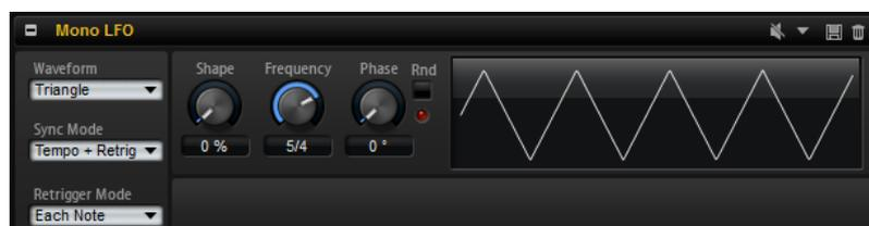
この場合のモノフォニックとは、LFO は 1 回だけ計算され、複数のボイスが同時にフィードされることを意味します。典型的な例は、モジュレーションホイールによってコントロールされたピッチモジュレーションで、1つの LFO がすべてのボイスのビブラートをコントロールする 場合です。モノフォニック LFO は、レイヤーまたはプログラムに含まれるゾーンのモジュレーションマトリクスでソースとして示されます。
