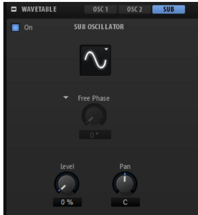
サブオシレーターのピッチは、ウェーブテーブルゾーンの全体的なピッチよりも常に1オクターブ低くなります。ウェーブテーブルゾーンのピッチを変調すると、サブオシレーターのピッチがそれに追従します。
