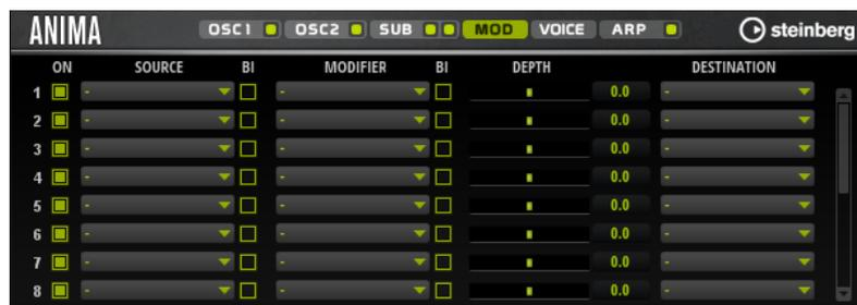
モジュレーションマトリクスでは、最大16種類のモジュレーションを使用できます。それぞれのモジュレーションには、デプスのソース、モディファイアおよびデスティネーションを設定できます。それぞれのソースとモディファイアの極性は、単極性と双極性を切り替えられます。
