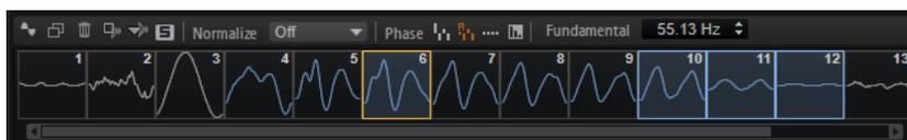
ウェーブテーブルエディターの下部には、ウェーブテーブルの概要が表示されます。選択されている波形は青色に設定されます。フォーカスされている波形はオレンジ色に設定されます。
