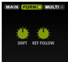
フォルマントとは、発音されたノートのスペクトラム内の倍音のことで、インストゥルメントの特徴を定義するのに役立ちます。スペクトラム内のフォルマントの位置は、ギターボディ、人体の声道の形、電子楽器のフィルター設定など、インストゥルメントの構造によって異なります。これらの条件によって、ノートのピッチに関係なく、特定の周波数範囲が強調されます。サンプルやウェーブテーブルをオリジナルとは異なるピッチで再生するには、通常、再生スピードを速くしたり遅くしたりします。これにより、すべての倍音も影響を受け、フォルマント特性が移動するため、良く知られている「**モンスター**」や「**ミッキーマウス**」のような状態になります。「**Formant**」オプションをオンにすることで、こういった事態を避けることができます。
