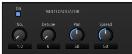
「Osc 1」と「Osc 2」に対して、**マルチオシレーターモード**を有効にできます。この機能を使用すると、最大 8 つのオシレーターを同時に生成して、よりリッチなサウンドを作れます。
