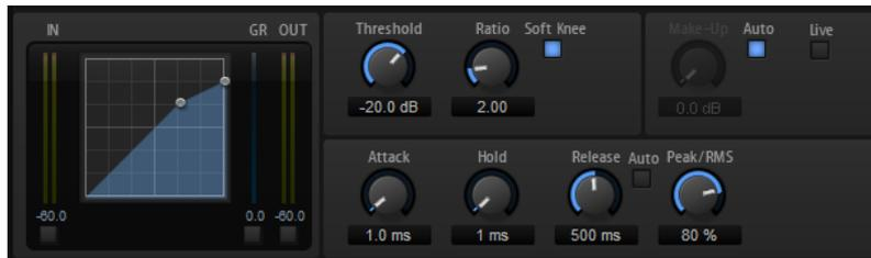
左側のグラフィックコントロールはコンプレッサー曲線を表わしています。このコントロールのハンドルを操作すると「スレッシュホールド」と「レシオ」の値を編集できます。入/出力 VU メーターは圧縮前と後のレベルを表示します。ゲインリダクションメーターは現在のレベル減衰を表示します。
