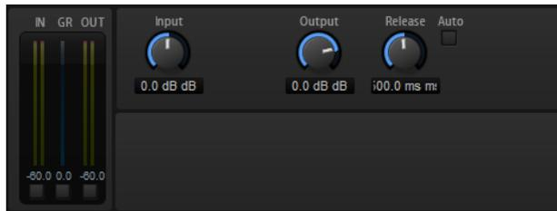
入/出力メーターはリミッター作動前と後のレベルを表示します。中央のゲインリダクションメーターは現在のレベル減衰を表示します。
