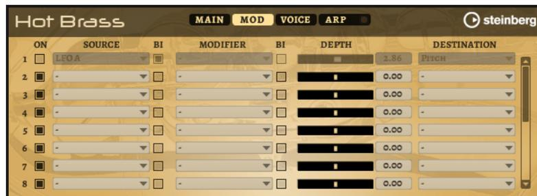
モジュレーションマトリクスでは、最大 16 種類のモジュレーションを使用できます。それぞれのモジュレーションには、デプスのソース、モディファイアーおよびデスティネーションを設定できます。それぞれのソースとモディファイアーの極性は、単極性と双極性を切り替えられます。
