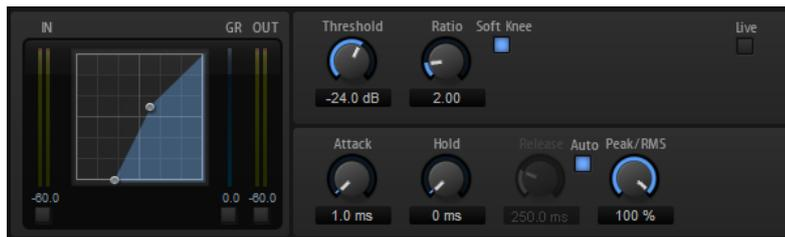
左側のグラフィックコントロールはエキスパンダー曲線を表わしています。このコントロールのハンドルを操作すると「スレッシュOLD」と「レシオ」の値を編集できます。入/出力メーターは拡大前と後のレベルを表示します。ゲインリダクションメーターは現在のレベル減衰を表示します。
