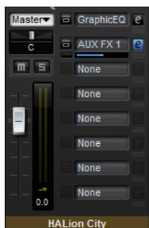
各 Insert は、コーラスやディレイのように標準的な Insert として使用することも、4 つの AUX Send エフェクトの 1 つをロードして AUX バスに信号を送信することもできます。すべてのスロット、プログラム、レイヤーバス、およびゾーンからこれらのバスに信号を部分的に送信できます。AUX Send エフェクトをロードすると、Insert スロットのレベルフェーダーを使用できるようになります。このフェーダーは、AUX バスに送信するレベルの設定に使用します。
