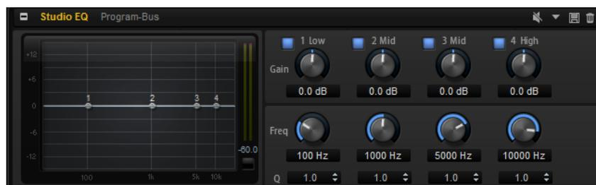
4つの周波数帯域で音質を補正できます。中域の2つはピークフィルターの働きをし、低域と高域はシェルピングフィルターの働きをします。全帯域が完全にパラメトリックになっており、ゲイン、周波数、およびQを設定できます。各周波数帯域について、次のコントロールを使用できます。
