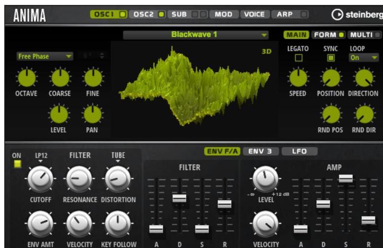
Anima では、並行して使用できる 2 つのウェーブテーブルオシレーターが提供されています。各オシレーターはマルチオシレーターを備えています。これにより、各オシレーターに対して最大 8 つの追加ボイスを生成し、個別にディチューンして、ステレオ全体に分散できます。
