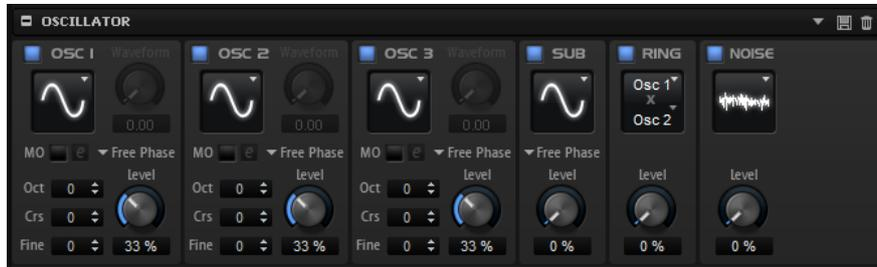
「Oscillator」セクションでは、6つの音源、つまり3つのメインオシレーター、サブオシレーター、リングモジュレーション、およびノイズジェネレーターが提供されています。これらの音源をミックスすることで、魅力的なサウンドの元となる波形を作ることができます。生成された信号は、さらにサウンド形成するために「Filter」セクションと「Amplifier」セクションに送られます。
