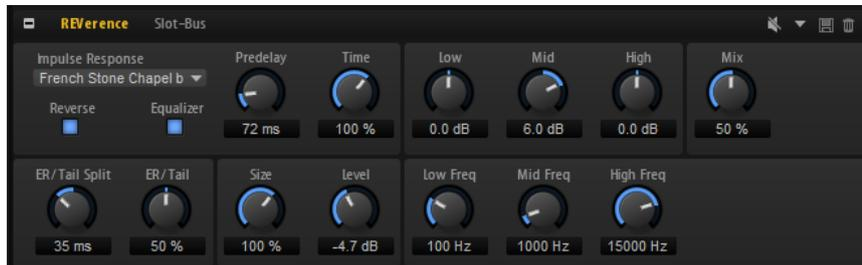
室内のインパルスを録音することで、室内の特性を表現できます。コンボリユーションによってこの特性をサウンドに重ね合わせていきます。結果としてきわめてナチュラルに響くリバーブが得られます。このエフェクトには高音質のリバーブインパルスレスポンスのコレクションが用意されています。
