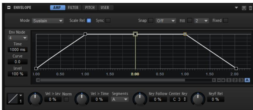
エンベロープの「Amp」、「Filter」および「Pitch」は、ゾーンの振幅、フィルターのカットオフ周波数、およびピッチにあらかじめ割り当てられます。「User」エンベロープは自由に割り当てることができます。
