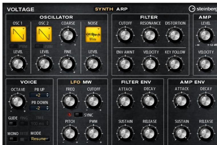
2つのオシレーターとノイズジェネレーターのあとには、24dB ローパスフィルターが続きます。フィルターは、キーボード、ベロシティ、LFOなどのモジュレーションソースだけでなく、たとえば、ステップシーケンサーのコントローラーレンでも変調できます。Voltageには、ピッチ、PWM、およびフィルターのモジュレーション用に2つのLFOが搭載されています。最初のLFOはホストアプリケーションのテンポに同期でき、フィルターおよびピッチのモジュレーションを可能にします。2番めのLFOは、モジュレーションホイールでコントロールされ、ビブラートの生成に使用されます。
