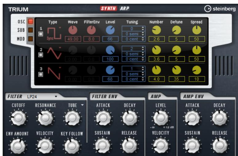
オシレーターのあとには、さまざまなフィルターシェイプを提供するマルチモードフィルターが続きます。フィルターは、キーボード、ベロシティ、LFOなどのモジュレーションソースだけでなく、たとえば、ステップシーケンサーのコントローラーレンでも変調できます。
