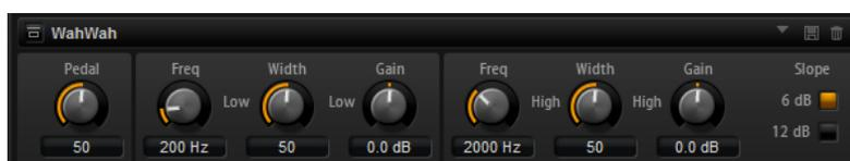
Vous pouvez régler indépendamment la fréquence, la largeur de bande et le gain pour les positions haute et basse de la pédale. Le point d'équilibre entre ces deux positions se situe à 50.
