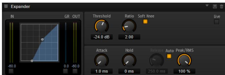
L'affichage graphique à gauche représente la courbe d'expansion. Vous pouvez éditer la valeur des paramètres **Threshold** et **Ratio** en utilisant les poignées de ce contrôle. Les vumètres d'entrée et de sortie indiquent le niveau avant et après expansion. Le vumètre de réduction de gain (GR) vous indique l'atténuation appliquée au niveau.
