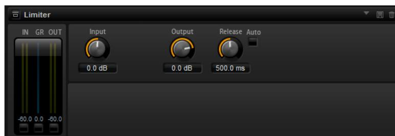
Les vumètres d'entrée et de sortie indiquent le niveau avant et après la limitation. Le vumètre de réduction de gain (GR) au milieu indique l'atténuation appliquée au niveau du son.
