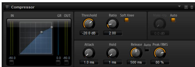
L'affichage graphique sur la gauche représente la courbe de compression. Vous pouvez éditer la valeur des paramètres **Threshold** et **Ratio** en utilisant les poignées de ce contrôle. Les vumètres d'entrée et de sortie indiquent les niveaux avant et après compression. Le vumètre de réduction de gain (GR) vous indique l'atténuation appliquée au niveau.
