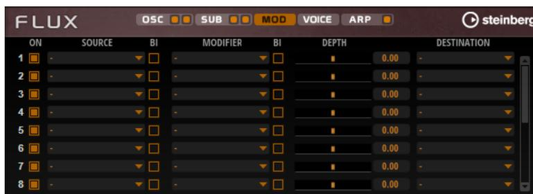
La matrice de modulation vous offre jusqu'à 16 modulations assignables librement, chacune disposant d'une source, d'un modificateur et d'une destination avec profondeur réglable. La polarité de chaque source et de chaque modificateur peut fonctionner de façon unipolaire ou bipolaire.
