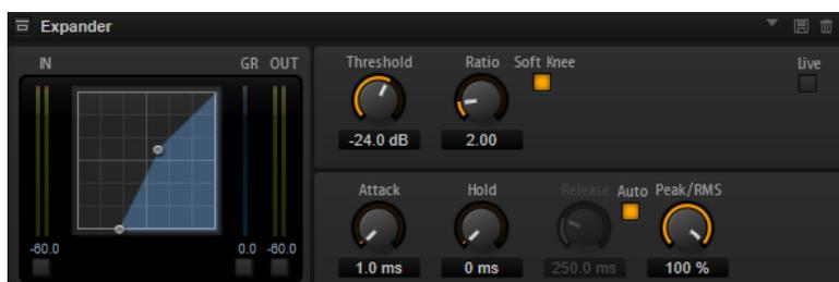
L'affichage graphique à gauche représente la courbe d'expansion. Vous pouvez éditer la valeur des paramètres **Threshold** (seuil) et **Ratio** en utilisant les poignées de ce contrôle. Les vumètres d'entrée et de sortie indiquent le niveau avant et après expansion. Le vumètre de réduction de gain (**GR**) vous indique l'atténuation appliquée au niveau.
