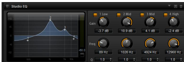
Les quatre bandes de fréquences vous permettent de configurer la tonalité du signal et de lui conférer un caractère plus brillant ou plus sombre, par exemple. Les deux bandes médium jouent le rôle de filtres en crêtes, tandis que les bandes basse et haute fonctionnent comme des filtres en plateau. Toutes les bandes sont entièrement paramétriques et offrent des paramètres de gain, de fréquence et de qualité. Voici les contrôles que vous pouvez trouver sur chaque bande de fréquence :
