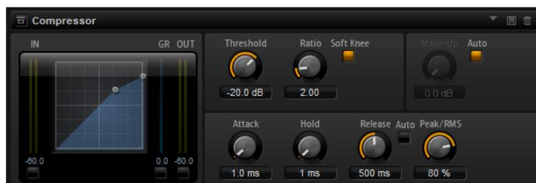
L'affichage graphique sur la gauche représente la courbe de compression. Vous pouvez éditer la valeur des paramètres **Threshold** (seuil) et **Ratio** en utilisant les poignées de ce contrôle. Les vumètres d'entrée et de sortie indiquent les niveaux avant et après compression. Le vumètre de réduction de gain (**GR**) vous indique l'atténuation appliquée au niveau.
