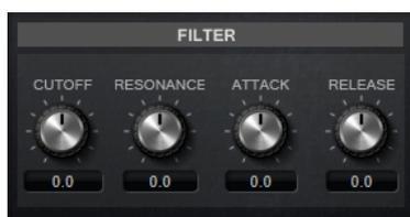
Cette section permet de régler les paramètres de filtrage. Ces paramètres fonctionnent comme des compensateurs, c'est-à-dire, qu'ils augmentent ou réduisent les valeurs courantes.
