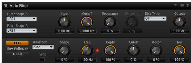
La fréquence de coupure et le morphing entre les deux formes de filtre peuvent être contrôlés via une pédale de contrôle, un LFO ou un profileur d'enveloppe (envelope follower).
