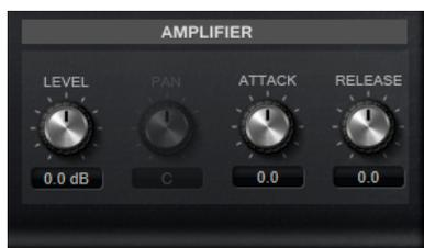
Cette section comprend les paramètres de niveau et de panoramique. Elle permet, en outre, de régler les temps d'attaque et de relâchement des enveloppes d'amplificateur, individuellement.
