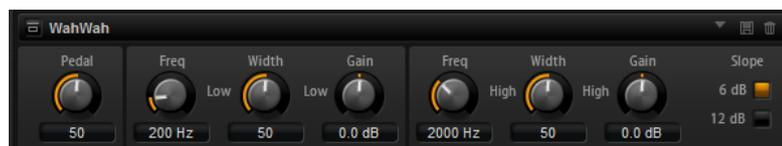
Vous pouvez régler indépendamment la fréquence, la largeur de bande et le gain pour les positions haute et basse de la pédale. Le point d'équilibre entre ces deux positions se situe à 50.
