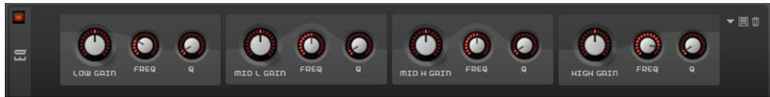
Les deux bandes médium jouent le rôle de filtres en crêtes, tandis que les bandes basse et haute fonctionnent comme des filtres en plateau. Toutes les bandes sont entièrement paramétriques et offrent des paramètres **Gain**, **Frequency** et **Q**.
