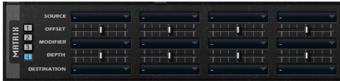
La matriz de modulación ofrece hasta 16 modulaciones libremente asignables, cada una con una fuente, un parámetro de desplazamiento, un modificador, y un destino con profundidad ajustable. Todas las fuentes y destinos de modulación se pueden asignar varias veces.
