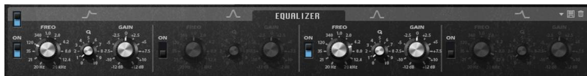
Con las 4 bandas de frecuencias, puede moldear el color del tono, para crear un sonido más brillante o más oscuro, por ejemplo. Las dos bandas de rango medio actúan como filtros de pico y las bandas baja y alta actúan como filtros de rampa (shelving). Todas las bandas son totalmente parametrizables con ganancia, frecuencia, y factor Q ajustables. Cada banda de frecuencia ofrece los siguientes controles:
