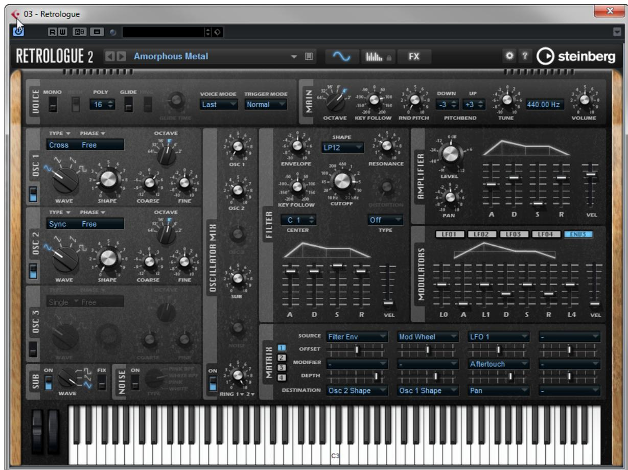
Retrologue viene con tres osciladores multimodo, un suboscilador dedicado y un generador de ruido. Los osciladores 1-3 tienen varios modos que le permiten hacer cualquier cosa, desde formas de onda de síntesis básica, pasando por modulación síncrona y cruzada, hasta formas de onda múltiples. Un oscilador puede ser una combinación de hasta ocho señales de osciladores desafinables, lo que le permite sonidos muy ricos. Además, puede añadir la señal modulada en anillo de los osciladores principales.
