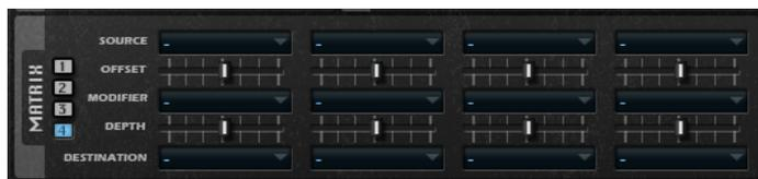
La matrice de modulation vous permet d'assigner librement jusqu'à 16 modulations, chacune comprenant une source, un paramètre de décalage, un modificateur et une destination dont l'ampleur peut être réglée. Toutes les sources et les destinations de modulation peuvent être assignées plusieurs fois.
