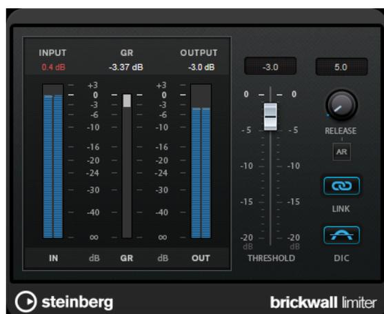
Debido a su rápido tiempo de ataque, **Brickwall Limiter** puede reducir incluso los picos de nivel del audio más corto sin crear anomalías audibles. Sin embargo, este plug-in crea una latencia de 1 ms. **Brickwall Limiter** ofrece medidores diferentes para la entrada, la salida y la cantidad de limitación. Coloque este plug-in al final de la cadena de señal, antes del dithering.
