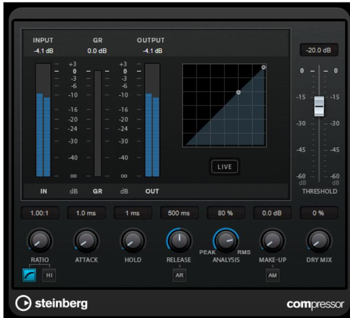
**Compressor** incluye un visor independiente que ilustra gráficamente la curva de compresión, cuya forma la definen los ajustes de los parámetros **Threshold** y **Ratio**. **Compressor** también tiene un medidor de **Gain Reduction** que muestra la cantidad de reducción de ganancia en dB, modos de compresión **Soft Knee/Hard Knee** y una funcionalidad Auto dependiente del programa para el parámetro **Release**.
