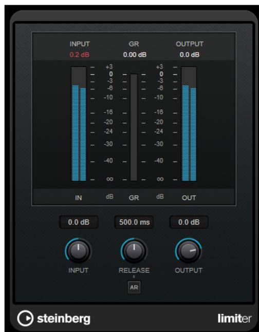
Il plug-in **Limiter** è in grado di regolare e ottimizzare automaticamente il parametro **Release** in base al materiale audio. In alternativa è possibile impostarlo manualmente. **Limiter** dispone
