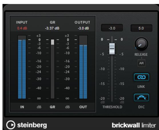
Grazie al suo rapido tempo di attacco, **Brickwall Limiter** è in grado di ridurre anche dei brevi picchi di livello nell'audio senza creare artefatti sonori udibili. Viene generata tuttavia una latenza di 1ms. **Brickwall Limiter** dispone di indicatori separati per il livello di ingresso, di uscita e per la quantità di limiting. Questo plug-in va posizionato alla fine della catena del segnale, prima dei plug-in di dithering.
