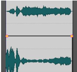
Die Hüllkurve zeigt an, ob Übergangspunkte, Fade-Ins oder Fade-Outs definiert wurden. Abgesehen von der Kurve werden Änderungen in der Pegel-Hüllkurve auch in der Wellenform dargestellt.
