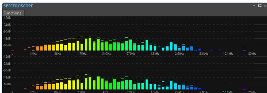
ピークレベルは、対応する帯域の上に水平線として表示され、最近のピーク値/最大値を示します。スペクトロスコープでは、スペクトラムの概要をすばやく確認できます。オーディオスペクトラムを詳細に解析する場合は、**スペクトロメーター**を使用します。
