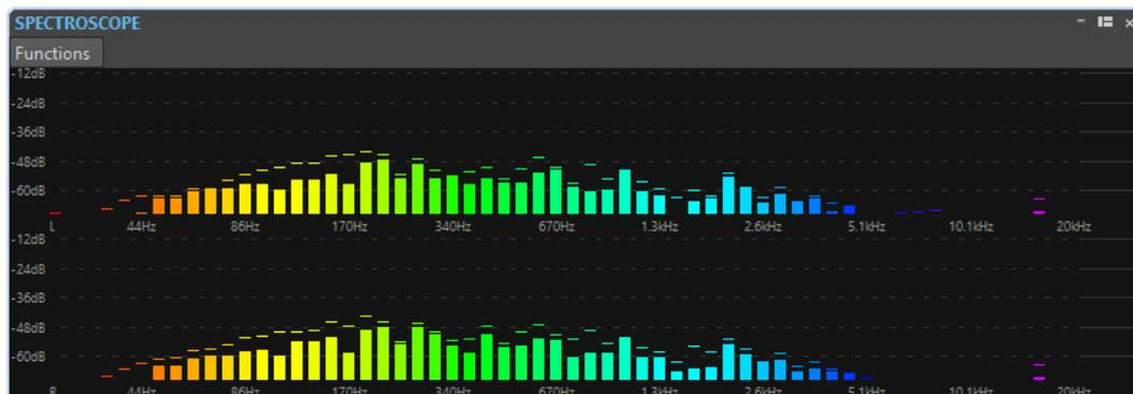
Spitzenpegel werden als horizontale Linien über den jeweiligen Bändern angezeigt und geben den letzten Wert/den Höchstwert an. Das **Spektroskop** bietet einen schnellen Überblick über das Spektrum. Für eine detailliertere Analyse des Audiospektrums verwenden Sie das **Spektrometer**.
