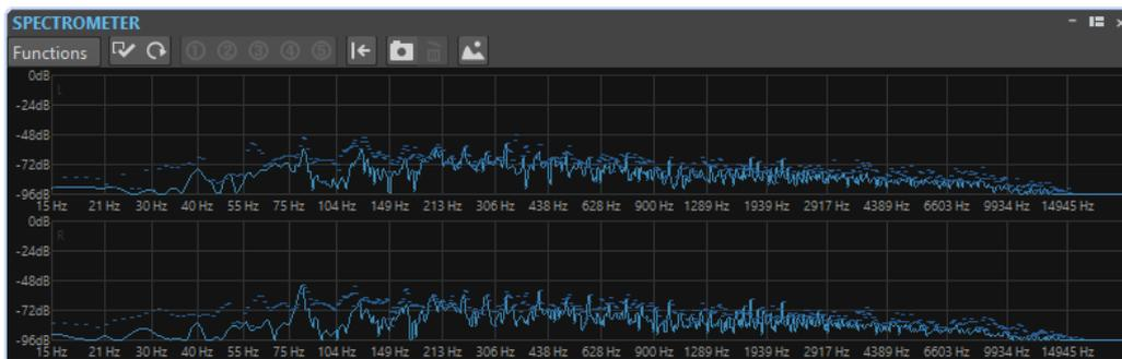
Das aktuelle Frequenzspektrum wird als lineares Diagramm angezeigt. Spektrumspitzen werden als kurze horizontale Linien angezeigt.
