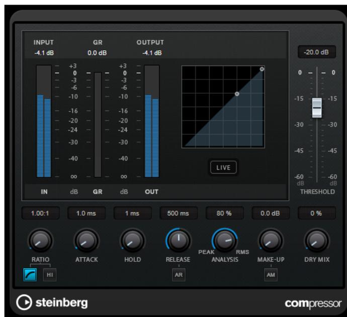
**Compressor** には、「Threshold」および「Ratio」パラメーターの設定に基づいた形のコンプレッサーカーブが個別にグラフィック表示されます。また、「Gain Reduction」メーターにはゲインの dB 単
