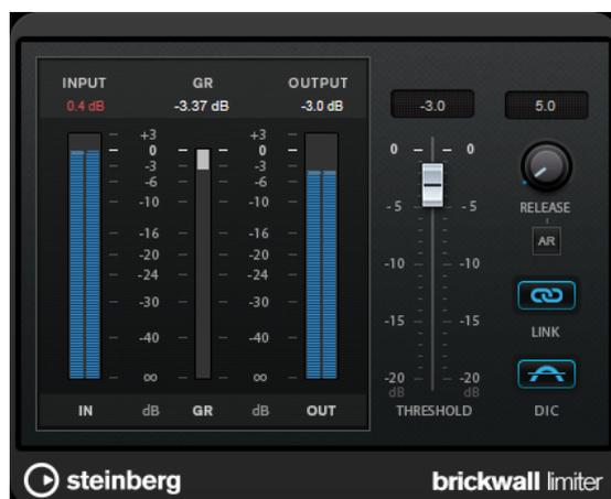
**Brickwall Limiter** では、アタックタイムが早いため、不自然な響きを発生させずに、瞬発的なオーディオレベルピークも低減できます。ただし、1 ミリ秒のレイテンシーが発生します。**Brickwall Limiter** には、入力、出力、および制限の量ごとのメーターがあります。このプラグインは、信号チェーンの最後、ディザリングの前に配置します。
