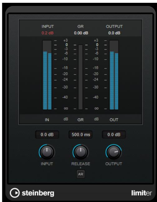
**Limiter** は、オーディオ素材に基づいて「Release」パラメーターを自動的に調整し、最適化できます。あるいは、このパラメーターを手動で設定することもできます。また、**Limiter** には入力、出力、および制限の量を個々に設定するためのメーターがあります (中央の各メーター)。
