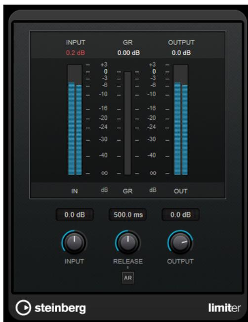
Il plug-in **Limiter** è in grado di regolare e ottimizzare automaticamente il parametro **Release** in base al materiale audio. In alternativa è possibile impostarlo manualmente. **Limiter** dispone di un indicatore separato per l'ingresso, l'uscita e la quantità di limitazione (indicatori centrali).
