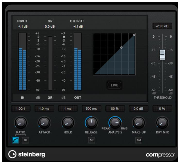
**Compressor** dispone di un display separato per la visualizzazione grafica della curva di compressione che viene modellata sulla base delle impostazioni dei parametri **Threshold** e **Ratio**. È presente anche un indicatore di **Gain Reduction (GR)** che visualizza la quantità di riduzione del guadagno in dB, le modalità di compressione **Soft Knee/Hard Knee** e una funzione Auto dipendente dal programma per il parametro **Release**.
