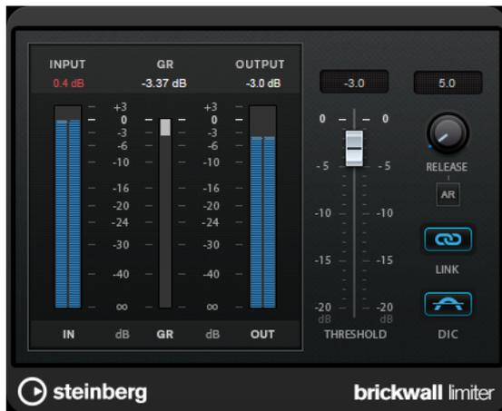
Durch seine schnelle Attack-Zeit kann der **Brickwall Limiter** sogar kurze Audiopegelspitzen reduzieren, ohne hörbare Artefakte zu erzeugen. Dieses PlugIn erzeugt jedoch eine Latenz von 1 ms. **Brickwall Limiter** bietet separate Anzeigen für den Eingangs- und Ausgangspegel sowie für den Grad der Begrenzung. Fügen Sie dieses PlugIn am Ende der Signalkette ein, vor dem Dithering.
