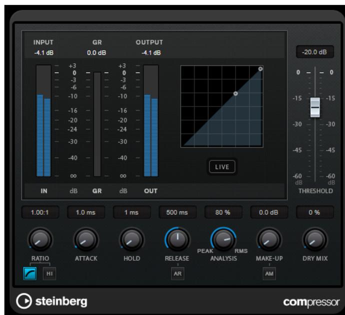
Der **Compressor** verfügt über eine separate Anzeige, die die Kompressorkurve darstellt, welche gemäß den Einstellungen der Parameter **Threshold** und **Ratio** geformt ist. Darüber hinaus bietet der **Compressor** ein Pegelreduktionsmeter (**Gain Reduction**) in dB, die Kompressionsmodi **Soft Knee**/**Hard Knee** sowie einen Schalter für eine automatische, programmabhängige **Release**-Einstellung.
