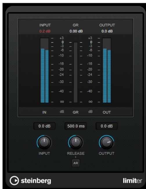
**Limiter** は、オーディオ素材に基づいて「**Release**」パラメーターを自動的に調整し、最適化できます。あるいは、このパラメーターを手動で設定することもできます。**Limiter** には、入力、出力、および制限の量を個々に設定するためのメーターがあります (中央の各メーター)。
