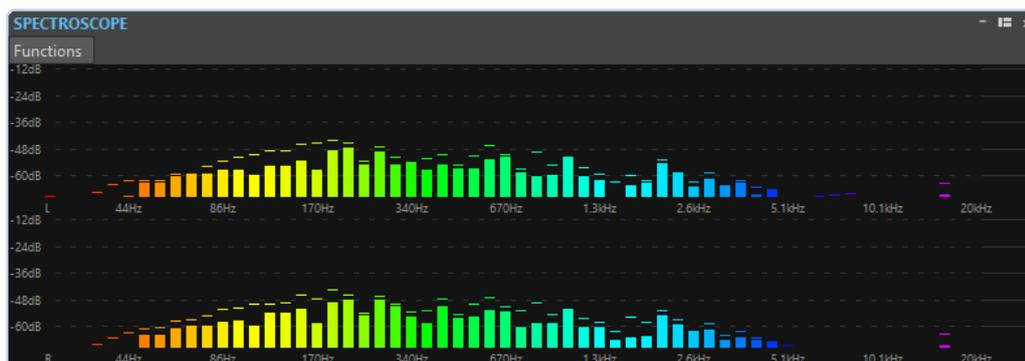
Les niveaux de crête sont représentés par des lignes horizontales au-dessus des bandes correspondantes, indiquant les valeurs de crête et maximales récentes. Le **Spectroscope** offre un aperçu rapide du spectre. Pour une analyse plus détaillée du spectre audio, utilisez le **Spectromètre**.
