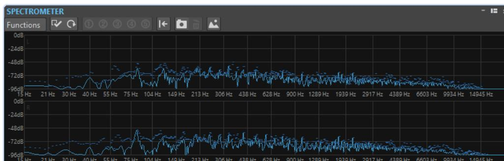
Le spectre de fréquence en cours est représenté sous forme d'un graphique linéaire. Les crêtes de spectre sont représentées par de courtes lignes horizontales.
