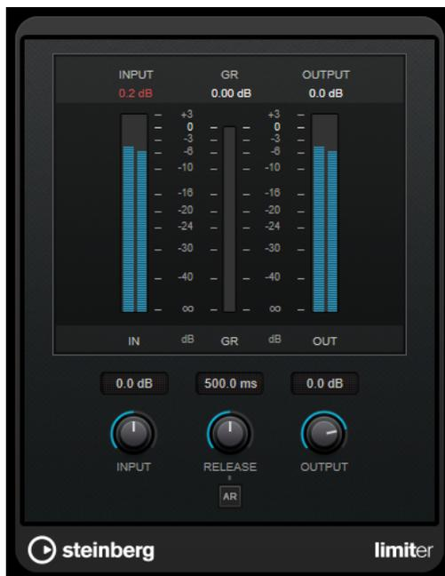
**Limiter** kann den **Release**-Parameter automatisch entsprechend dem Audiomaterial anpassen und optimieren; Sie können den Parameter aber auch manuell einstellen. **Limiter** bietet separate Meter für den Eingangs- und Ausgangspegel sowie für den Grad des Limitings (mittleres Meter).
