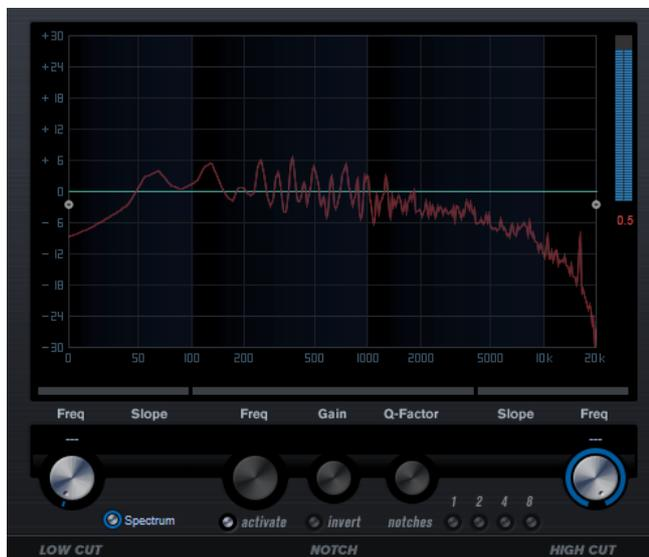
**PostFilter** kombiniert ein Hochpass-, ein Kerb- und ein Tiefpassfilter. Sie können Einstellungen vornehmen, indem Sie an den Kurvenpunkten in der Anzeige ziehen, oder die Bedienelemente unterhalb der Anzeige verwenden.
