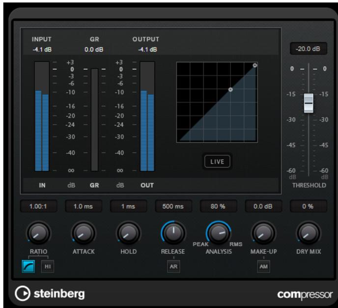
Der **Compressor** verfügt außerdem über eine separate Anzeige, die die Kompressorkurve darstellt, welche gemäß den Einstellungen der Parameter **Threshold** und **Ratio** geformt ist. Darüber hinaus bietet der **Compressor** ein Pegelreduktionsmeter (**Gain Reduction**) in dB, die Kompressionsmodi **Soft Knee/Hard Knee** sowie einen Schalter für eine automatische, programmunabhängige **Release**-Einstellung.
