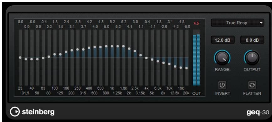
Jedes Frequenzband kann um 12 dB gedämpft oder verstärkt werden, was eine Feineinstellung der Frequenzbereiche ermöglicht. Zusätzlich sind mehrere Preset-Modi verfügbar, die dem Klang des **GEQ-10/GEQ-30** Farbe hinzufügen.
