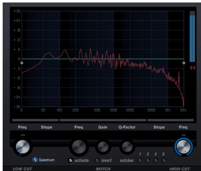
**PostFilter** combina un filtro de corte bajo, un filtro de notch y un filtro de corte alto. Puede hacer ajustes arrastrando los puntos de la curva en el visor gráfico, o ajustando los controles de debajo del visor.
