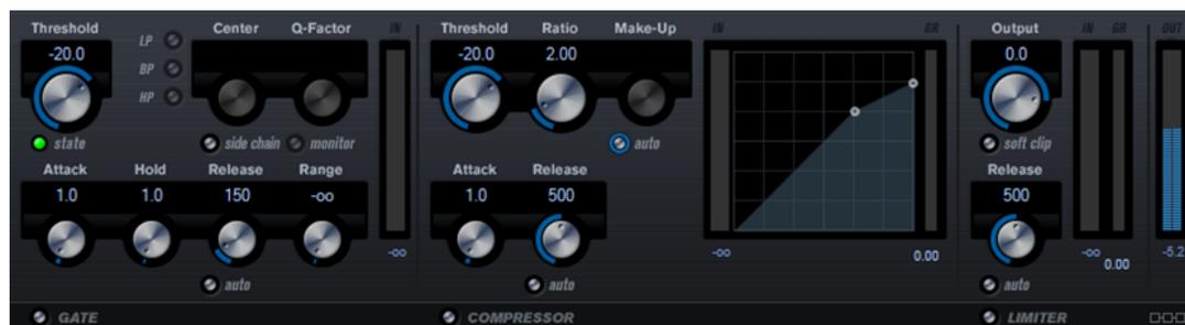
La ventana se divide en tres secciones, cada una conteniendo controles y medidores para cada procesador. Active cada uno de los procesadores con los botones **Gate**, **Compressor**, y **Limiter** de la parte inferior del panel del plug-in.
