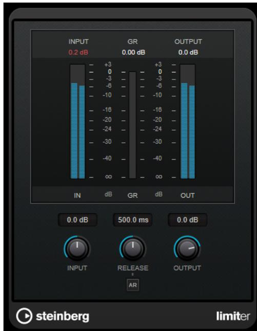
**Limiter** puede ajustar y optimizar automáticamente el parámetro **Release** según el material de audio, pero también se puede ajustar manualmente. **Limiter** también tiene medidores diferentes para la entrada, la salida y la cantidad de limitación (medidores centrales).
