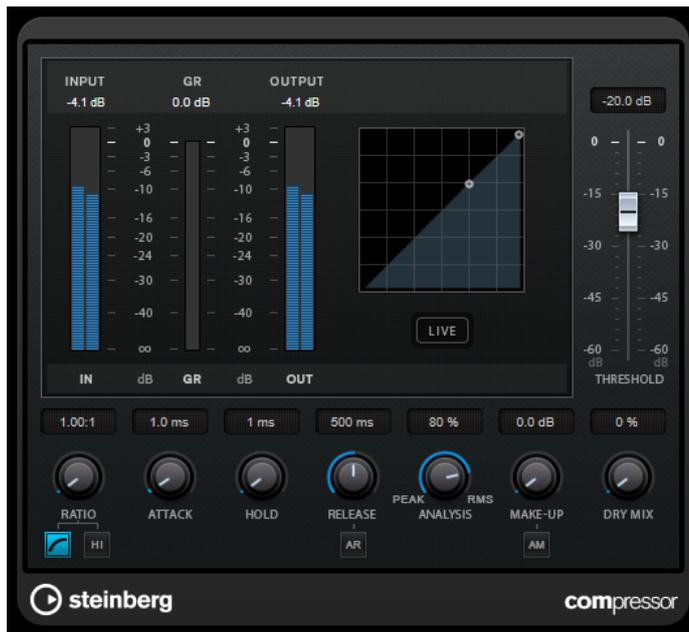
**Compressor** incluye un visor independiente que ilustra gráficamente la curva de compresión, cuya forma la definen los ajustes de los parámetros **Threshold** y **Ratio**. **Compressor** también tiene un medidor **Gain Reduction** que muestra la cantidad de reducción de ganancia en dB, modos de compresión **Soft Knee/Hard Knee** y una función auto para el parámetro **Release** que depende del programa.
